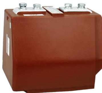
ТОЛ-10 трансформатор тока предназначен для передачи сигнала измерительной информации приборам измерения, защиты, автоматики, сигнализации и управления в электрических цепях переменного тока частотой 50 Гц. Устанавливаются в комплектные распределительные устройства (КРУ) внутренней и наружной установки, а также в сборные камеры одностороннего обслуживания (КСО).
